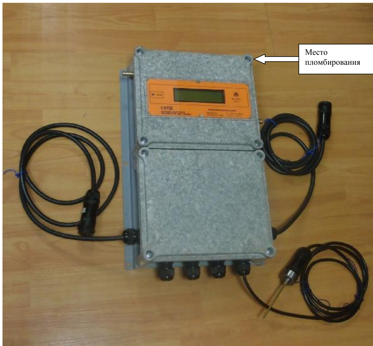
Рисунок 1 – Внешний вид станции контроля параметров дегазации СКПД
